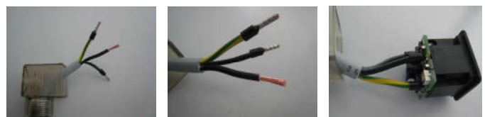
Durchziehen, Abmanteln Abisolieren, Aderendhülsen Polrichtig anschließen
