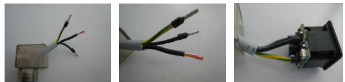
Durchziehen, Abmanteln Abisolieren, Aderendhülsen Polrichtig anschließen
